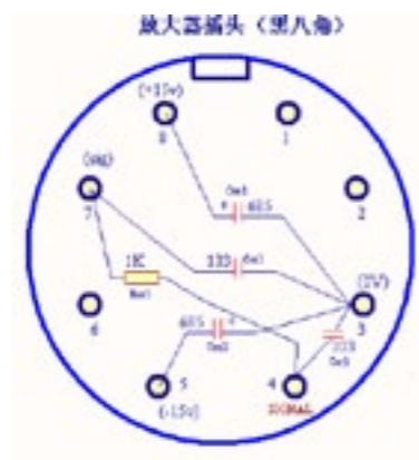
图 2-5 放大器插头内部结构图
