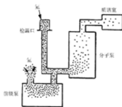
图 B-1 逆扩散原理
